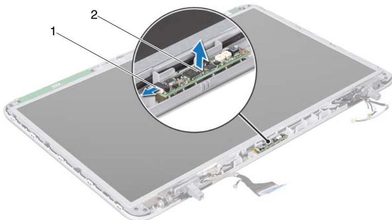
1 kabel pločice IR odašiljača
